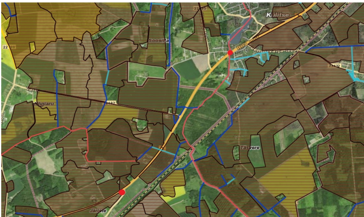
Joonis 2.2. Kavandatav Kõlitse – Järliste jalgratta- ja jalgteede asukoht (algus ja lõpp tähistatud punase täpiga, kulgeb paralleelselt maanteega) maaparandussüsteemide alal. Aluskaart: Maa-amet, 2022.
